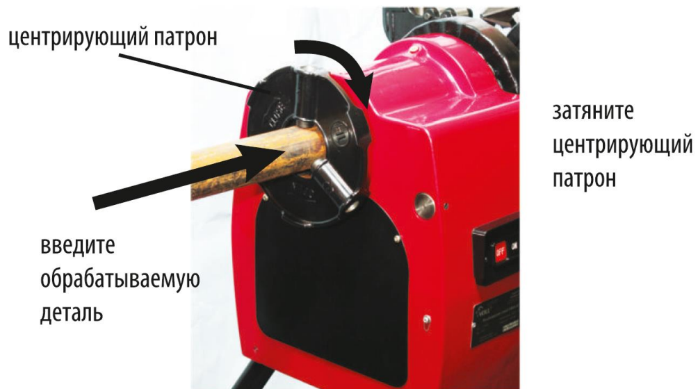
Рис. 4 Фиксация трубы в центрирующем зажимном патроне
