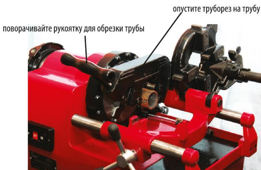
Рис. 7 Затягивайте труборез по ½ оборота за полный оборот трубы
