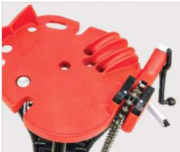
Пазы для навешивания инструмента и встроенный трубогиб
