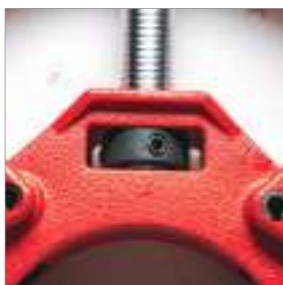
Резьбовой механизм прижима роликов
