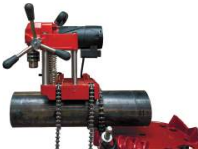
Надёжная фиксация на трубе при помощи цепных держателей
