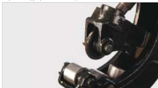
Встроенный труборез со сменным диском
