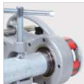
Установка клуппа на трубу с помощью струбины
