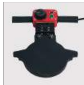
Нагревательный элемент с регулировкой t° до 300 °C
