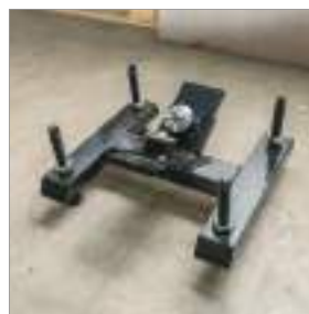
Роликовая опора в комплекте с труборезом
