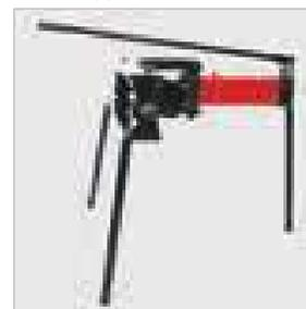
Боковые упоры устанавливаются в отверстия в соответствии с Ø трубы
