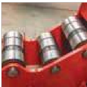
Роликовая опора в комплекте
